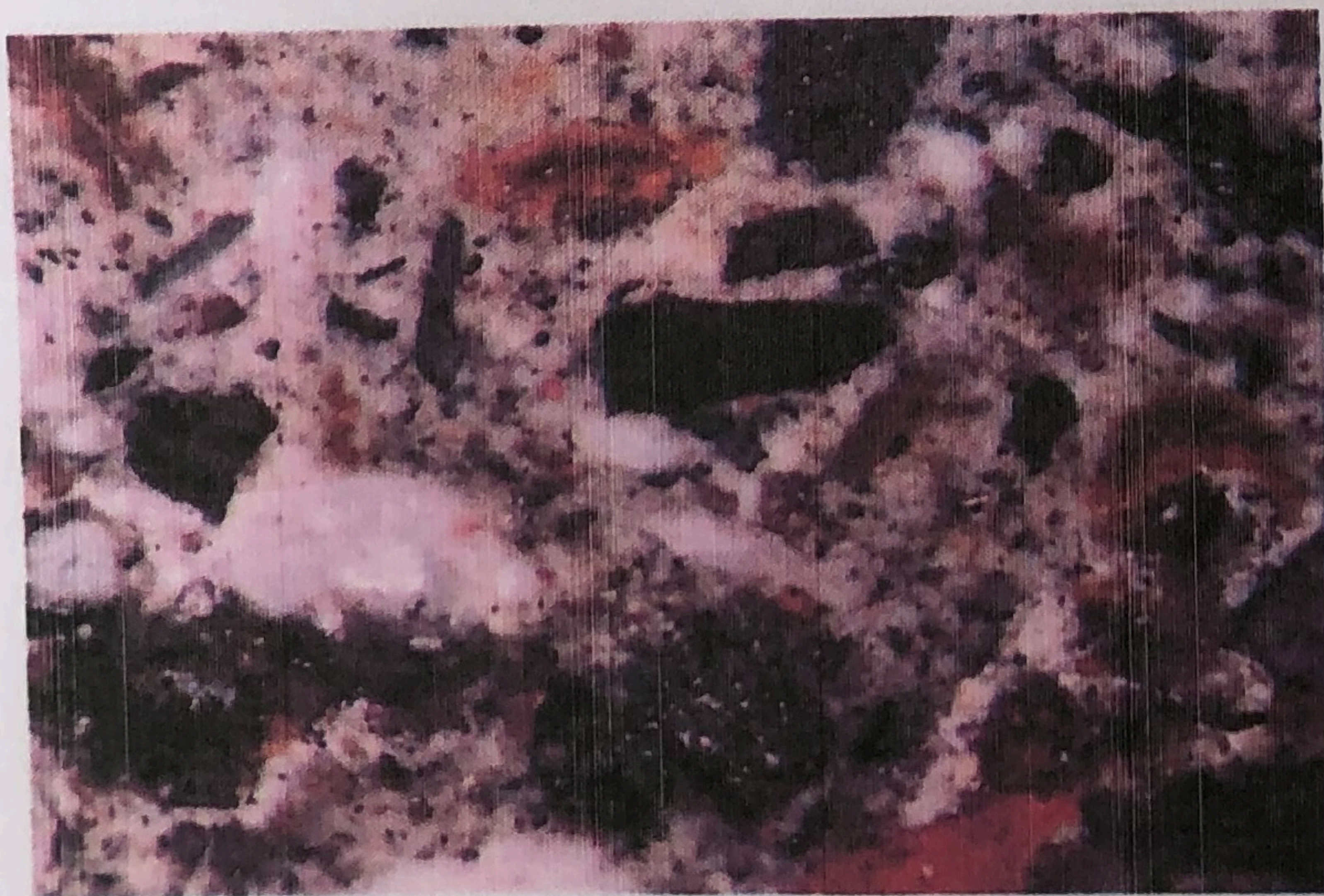
Obr. 5: Struktura a barevnost nabroušeného vzorku
