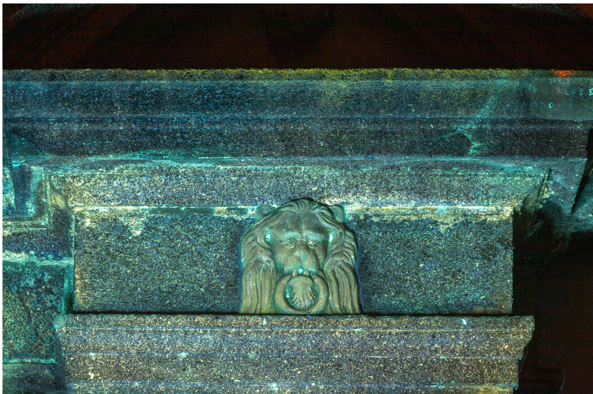
Obr. 68 Ultrafialová fluorescenční fotografie (UVF), detail lví hlavy na kladí.
