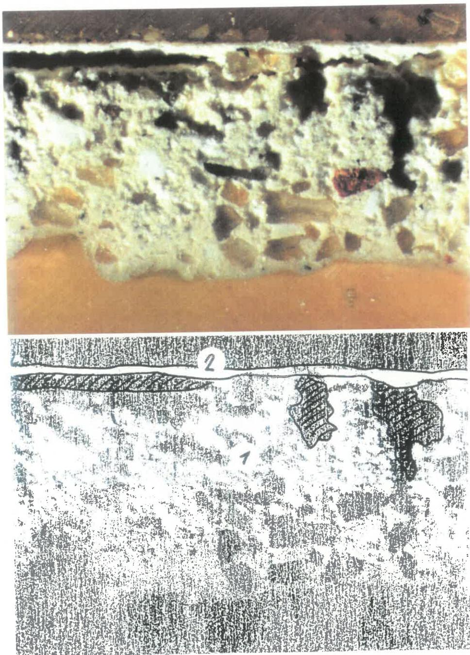
4b) Fotografie při zvětšení 40x. Vzorek se skládá ze tří vrstev omítky, z nichž vrstva 2 je fragmentální a vrstva 3 je narušena dutinami. Na povrchu se nachází šedý nátěr 5.
