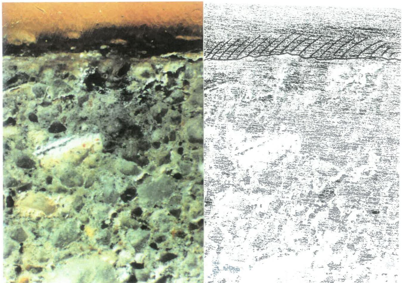
3a) Fotografie při zvětšení 40x. Mnohovrstevný vzorek obsahuje 1 pravděpodobně zbytek omítky, všechny ostatní vrstvy jsou barevné nářery a vrstva 9 a 10 má charakter vápenné omítky. Na jejím povrchu je mezivrstva nečistot a čistě bílý popraskaný nátěr 11. Pravděpodobně původní barevná vrstva je vrstva 2 tvořená nepigmentovaným vápnem.
