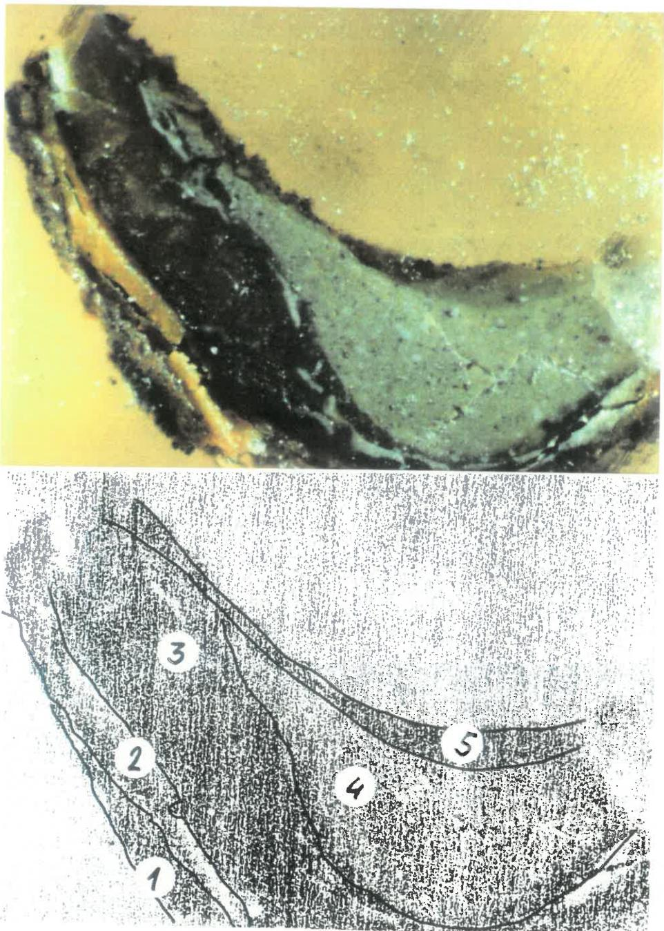
4a) Fotografie při zvětšení 40x. Na snímku je patrná silná vrstva omítky 1, která obsahuje řadu dutin, zvláště při povrchu (šrafování). Povrch je opatřen bílým vápenným nátěrem.
