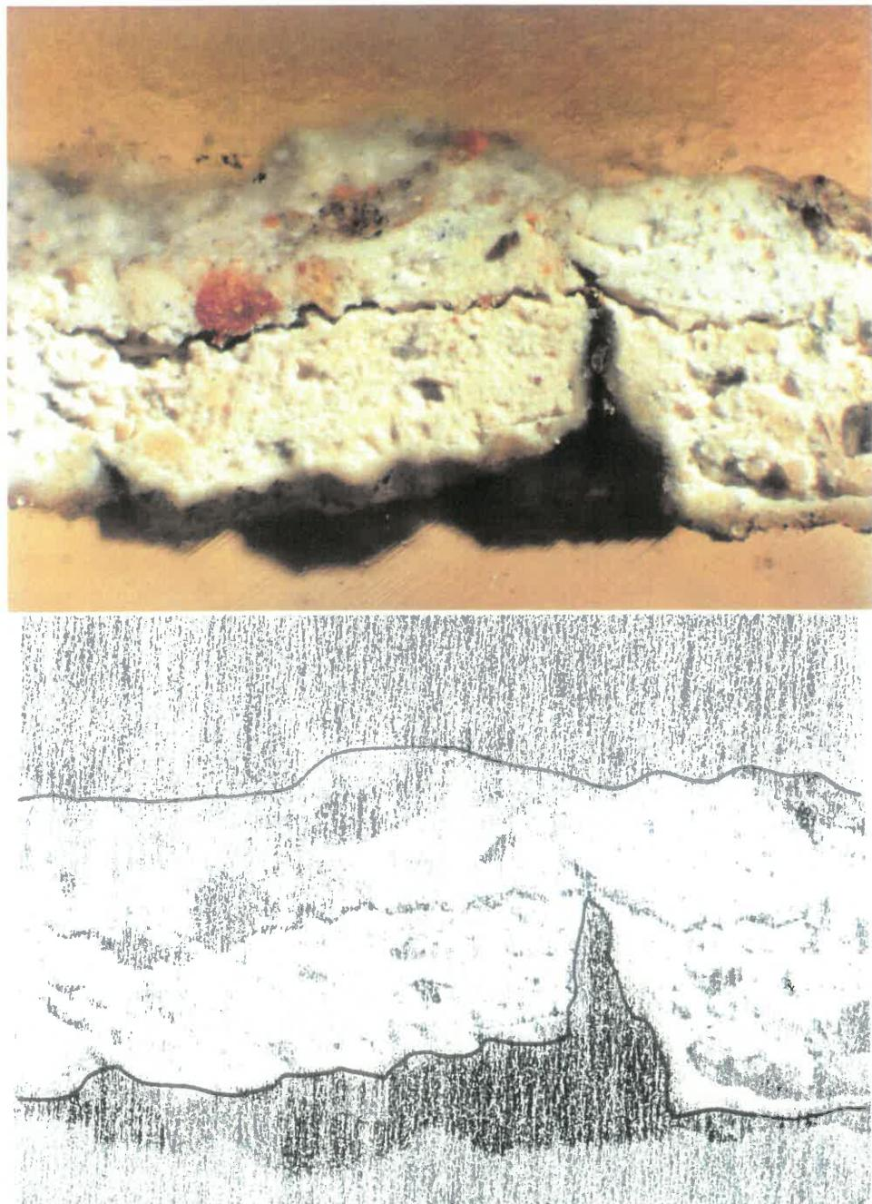
5b) Fotografie při zvětšení 40x. Vrstva 1 je s červeným zrnem je táz jako u vzorku 5b. Následuje mezivrstva nečistot, omítková vrstva 2, nečistoty, vrstvy 3, 4, 5 byly patrně naneseny zároveň nebo po očištění povrchu, následují nečistoty a šedý nátěr 6.
