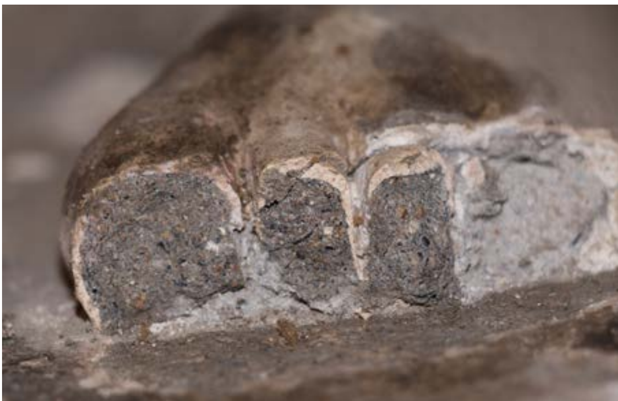
Obr. 12 Chodidlo Adama - stratigrafie štukových vrstev (zvýraznění vrstev po navlhčení vodou). Na tmavé jádro s příměsí okujů byla nanášena velmi tenká vrstva jemnozrnného štuky.
