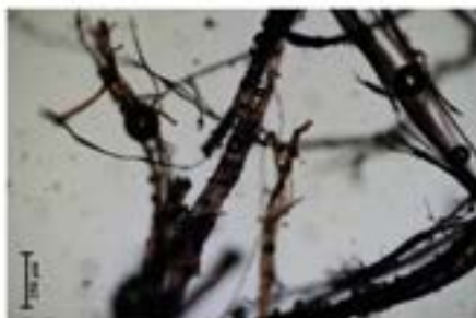
Snímky vláken vzorku V12/9654, po obarvení Herzbergovým činidlem. Fotografováno na optickém mikroskopu Nikon ECLIPSE LV100 při zvětšení na mikroskopu 50x, 100x a 200x v bílém dopadajícím světle
