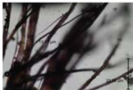
Snímky vláken vzorku V12/9654, po obarvení Herzbergovým činidlem. Fotografováno na optickém mikroskopu Nikon ECLIPSE LV100 při zvětšení na mikroskopu 50x, 100x a 200x v bílém dopadajícím světle
