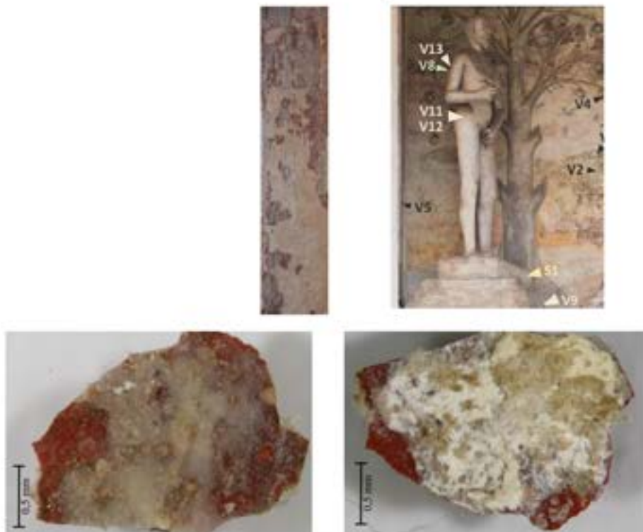
Detail místa odběru vzorku V5/9670 a lokalizace místa odběru na objektu. Makrosvětelné lícové (vlevo) a rohové strany (vpravo) vzorku. Fotografováno na stereomikroskopu SMZ800 (Nikon), bílé dopadající světlo, zvětšení na mikroskopu 3x.
